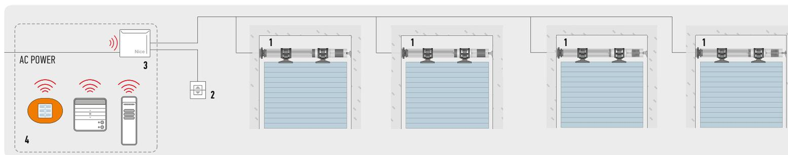
1. MOTEUR TUBULAIRE 2. BOUTON MONTÉE/DESCENTE GÉNÉRAL 3. CENTRALE DE COMMANDE SÉRIE TT4 4. ÉMETTEUR POUR COMMANDE INDIVIDUELLE OU DE GROUPE
